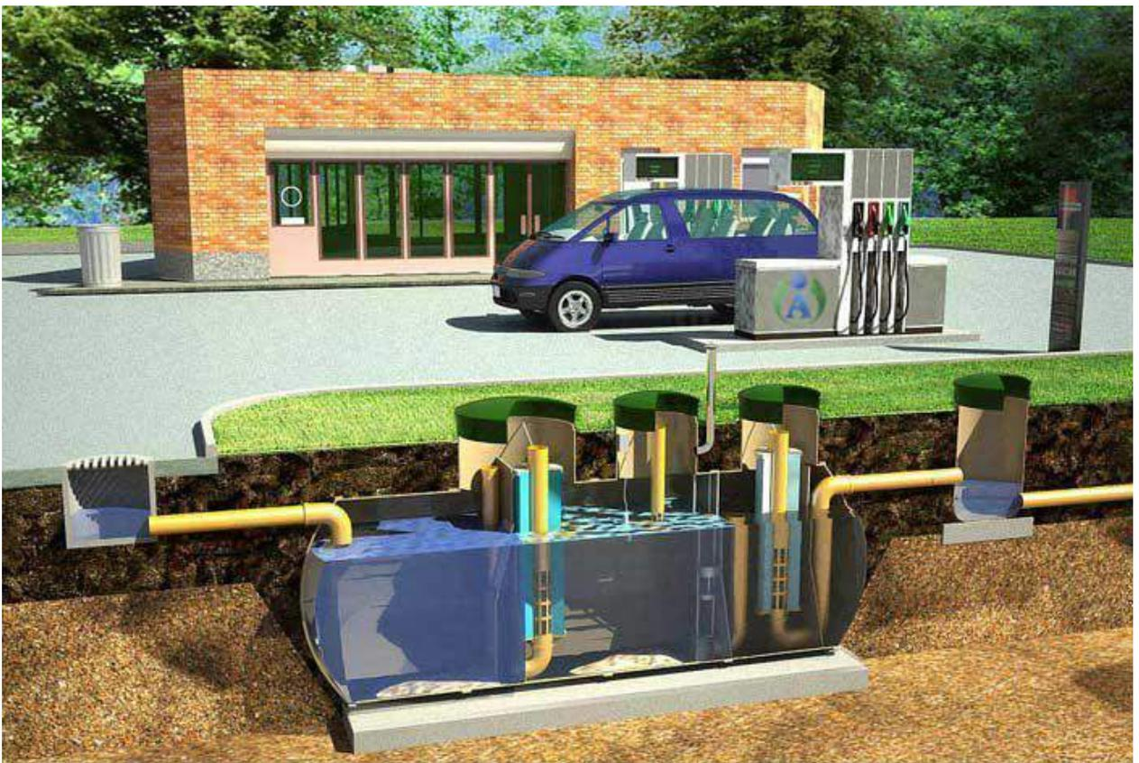
**Рисунок 10. Схема очистного сооружения ливневой канализации.**
