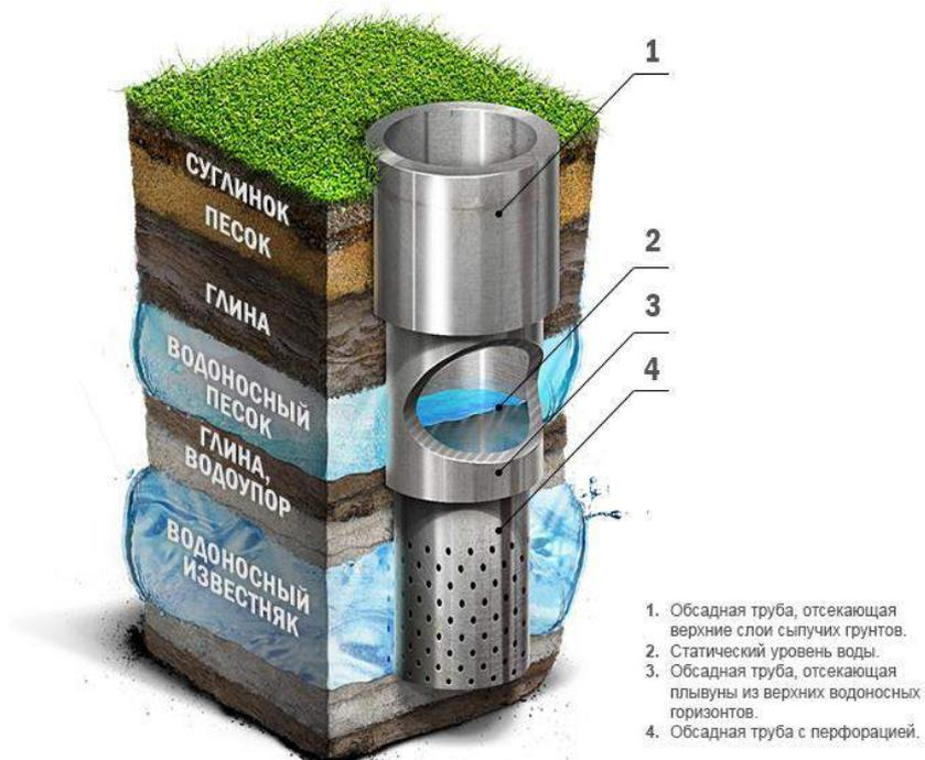
**Рисунок 6. Схема артезианской скважины.**
